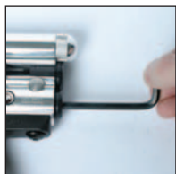
FIGURE 6. RÉGLAGE DE LA VÉLOCITÉ AVEC UNE CLEF ALLEN DE 3/16 PO.
