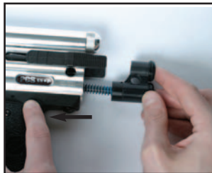
FIGURE 19—Bouton de retrait de la gâchette (semi-automatique)
