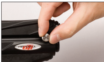
Figura 8. Retire el pasador de desmontaje en juego para comenzar a desmontar la marcadora.
