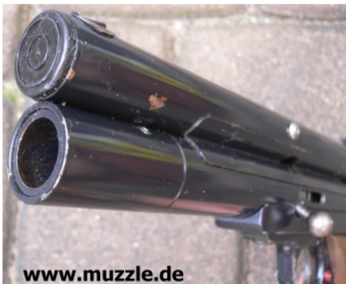
Bilder unten: Mündungsansicht - Das obere Rohr beherbergt das Magazin, der Lauf sitzt unten.
